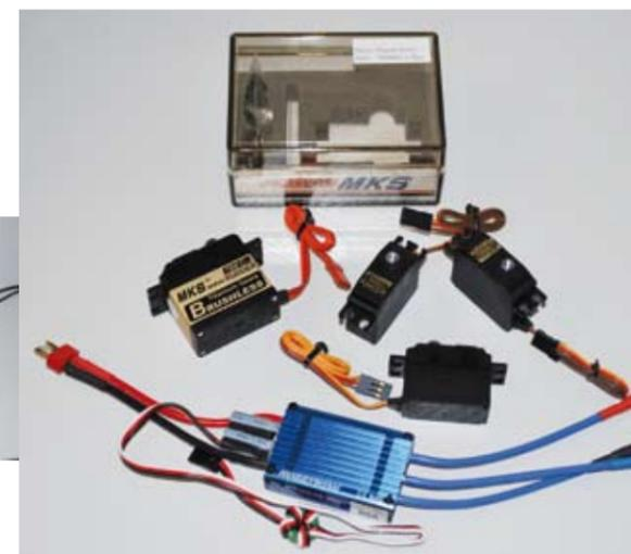
Die verwendeten MKS-Digitalservos DS 9660 für die Taumelscheibe und das Brushless-Heckservo BLS 980 in Standardgröße mit einem Neutralimpuls von 760 µs und 560 Hertz. Im Vordergrund der zum Lieferumfang gehörende Controller Hobbywing 60 Ampere mit BEC
