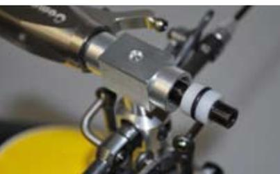
Dämpfung des Hauptrotorkopfs: Die Blattlagerwelle sitzt in einer Kunststoffbuchse, die wiederum mit einem O-Ring im Zentralstück gedämpft wird
