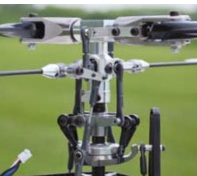
Der Hauptrotorkopf mit untenliegender Stabilisierungstange. Pitchkompensator und Taumelscheibe sind leichtgängig, präzise und machen einen hervorragenden Eindruck
