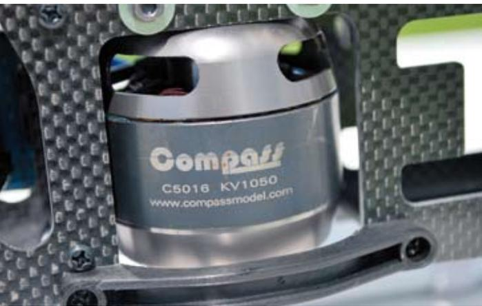
Der Motor Compass C5016 mit einer Drehzahl von 1.050 Umdrehungen pro Volt ist ein echter Kraftprotz und kommt mit dem Heli spielend zurecht
