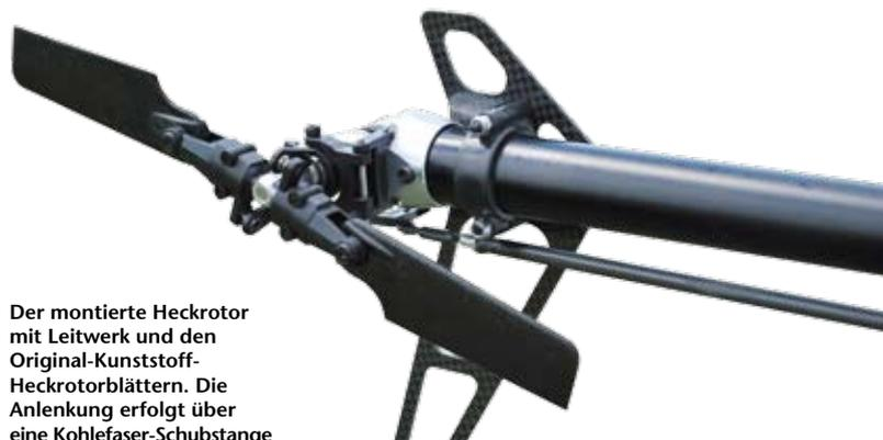
Der montierte Heckrotor mit Leitwerk und den Original-Kunststoff-Heckrotorblättern. Die Anlenkung erfolgt über eine Kohlefaser-Schubstange
