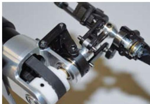
Eine demontierte Hälfte des Blatthalters verdeutlicht den Aufbau. Hier sind sowohl ein Radial- als auch ein Axiallager integriert
