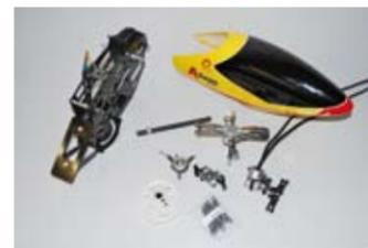
Lieferumfang der Hauptkomponenten. Taumelscheibe, Pitchkompensator, Rotorkopf sind leichtgängig, kugelgelagert und sehr gut montiert. Eine Kontrolle ergab, dass alle Vormontagen sorgfältig vorgenommen wurden und an den relevanten Stellen Schraubensicherung vorhanden war
